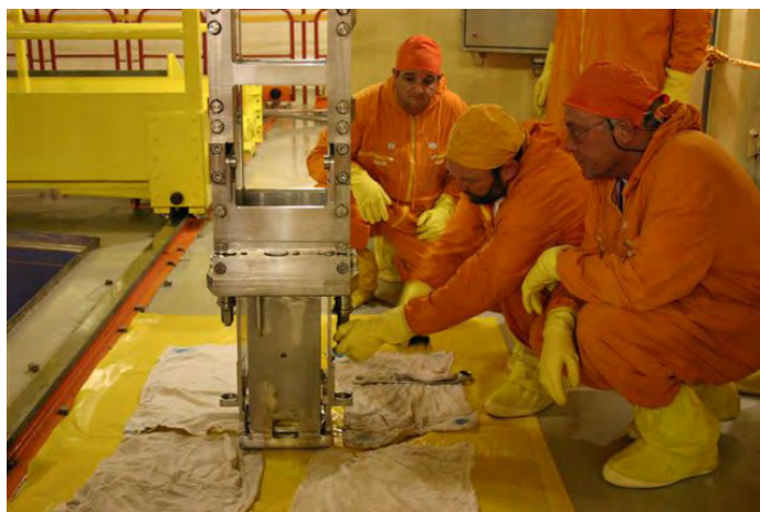
Profissionais trabalhando com reparo de Elementos Combustíveis de Angra 2
